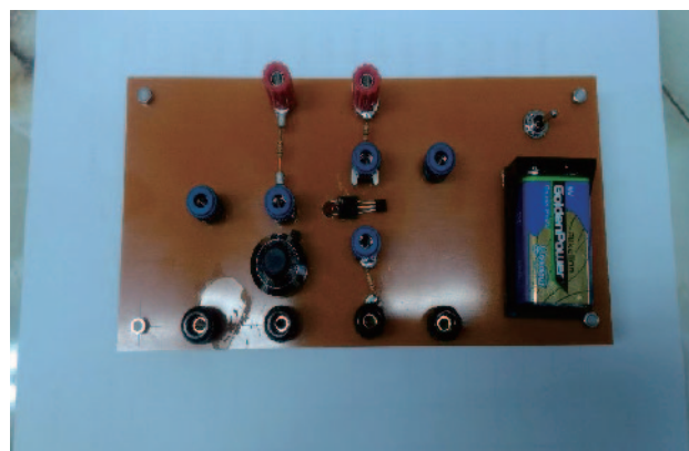
図 2 D1 ボードの写真 配線は裏面で行っている。
